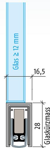
Dichtungshöhe bis 18 mm
