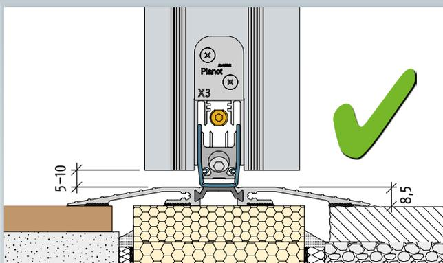
Neubau mit thermisch getrennter Flachschwelle F140 und Planet X3
