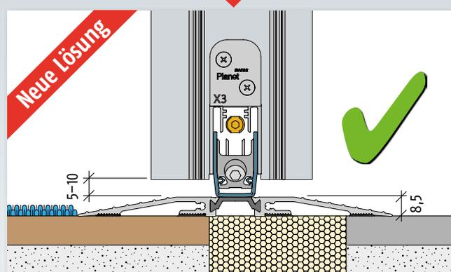
Renovation mit thermisch getrennter Flachschwelle F140 und Planet X3
