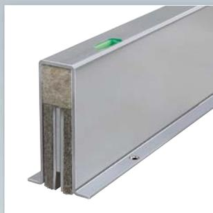
**Option:** Planet BL mit Planet Bohrung  $\varnothing 5 \times 13$  mm für Kantriegel (nur bis 2 mm Bleieinlage möglich, Mindestlänge 400 mm).
