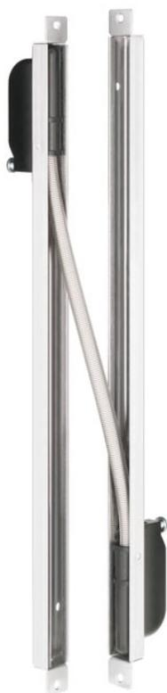
Mit dem verdeckten Kabelübergang ist es möglich, Zuleitungen kontrolliert und sicher von der Türzarge zum Türblatt zu führen. Durch die verdeckte Montage im Türfalz ist die Zuleitung bei geschlossener Tür nicht zugänglich und damit sabotagesicher. Da die Zuleitung durch den Spiralschlauch aus Metall geführt wird, ist eine Beschädigung durch Abknicken oder Einklemmen ausgeschlossen.
