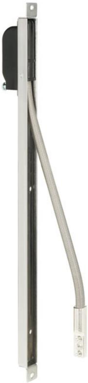
Mit dem verdeckten Kabelübergang ist es möglich, Zuleitungen kontrolliert und sicher von der Türzarge zum Türblatt zu führen. Durch die verdeckte Montage im Türfalz ist die Zuleitung bei geschlossener Tür nicht zugänglich und damit sabotagesicher. Da die Zuleitung durch den Spiralschlauch aus Metall geführt wird, ist eine Beschädigung durch Abknicken oder Einklemmen ausgeschlossen.
