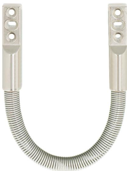
Mit dem verdeckten Kabelübergang ist es möglich, Zuleitungen kontrolliert und sicher von der Türzarge zum Türblatt zu führen. Durch die verdeckte Montage im Türfalz ist die Zuleitung bei geschlossener Tür nicht zugänglich und damit sabotagesicher. Da die Zuleitung durch den Spiralschlauch aus Metall geführt wird, ist eine Beschädigung durch Abknicken oder Einklemmen ausgeschlossen.
