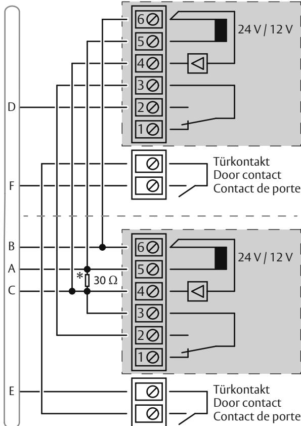
Die Betriebsspannungen von Steuergerät und Haftmagnet müssen gleich sein.
