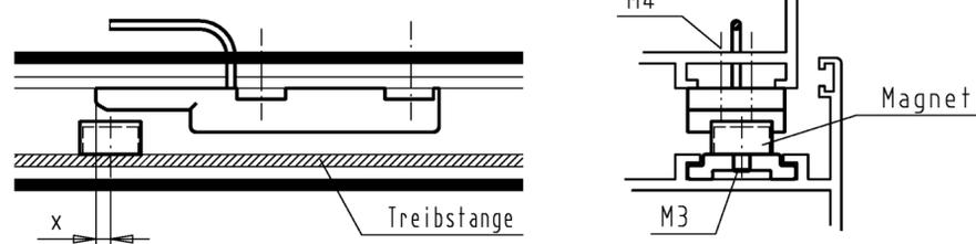
\* 4Stck. Senkschrauben M4 zur Befestigung des Magnetenschalters stellt Fensterhersteller
