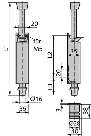
**Türfeststeller mit Bodenbuchse**
