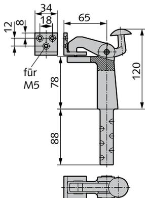
**Torfeststeller mit Steindolle zum Einmauern**
