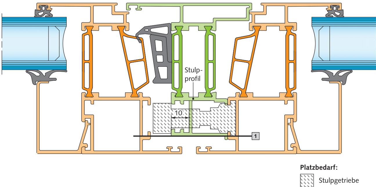
Die Rahmenteile des Verschluss-Sets sind passend für alle gängigen Euro-Nut-Profile; Rahmennut 10–14 mm. Die Auswahl der Bandseite ist abhängig von den Klemmstegen der Rahmennut. Nutzen Sie bitte die Bandauswahl auf Seite 7.
