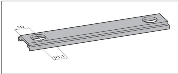
Lochung mit einem Durchmesser von 10,1 mm
