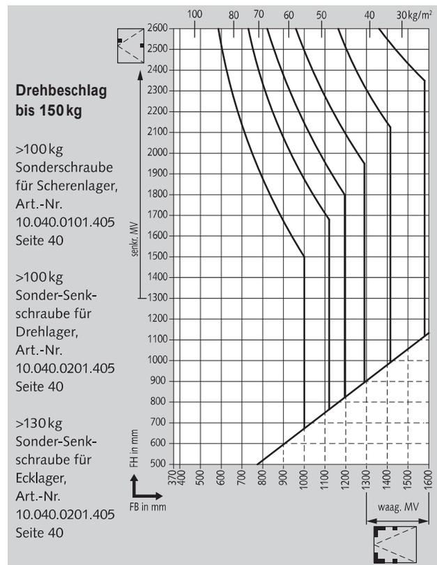
**Kippbeschläge:** Flügelgewicht max. 150 kg Zusatzverriegelungen analog zu Drehbeschlägen ab 1.300mm Flügelbreite und -höhe.
