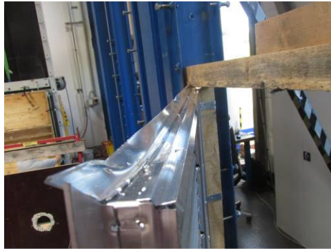
Bild 7 Schäden aus der manuellen Prüfung der Mauerwerksanker
