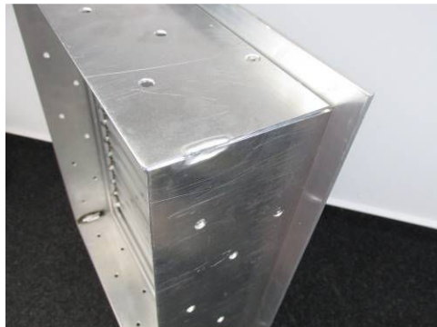
Bild 9 Modifiziertes Befestigungsblech angenietet, umlaufend und an den Ecken verschweißt
