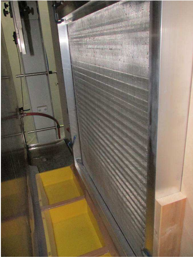
Bild 3 Rückansicht des Prüfaufbaus mit Auffangbehältern
