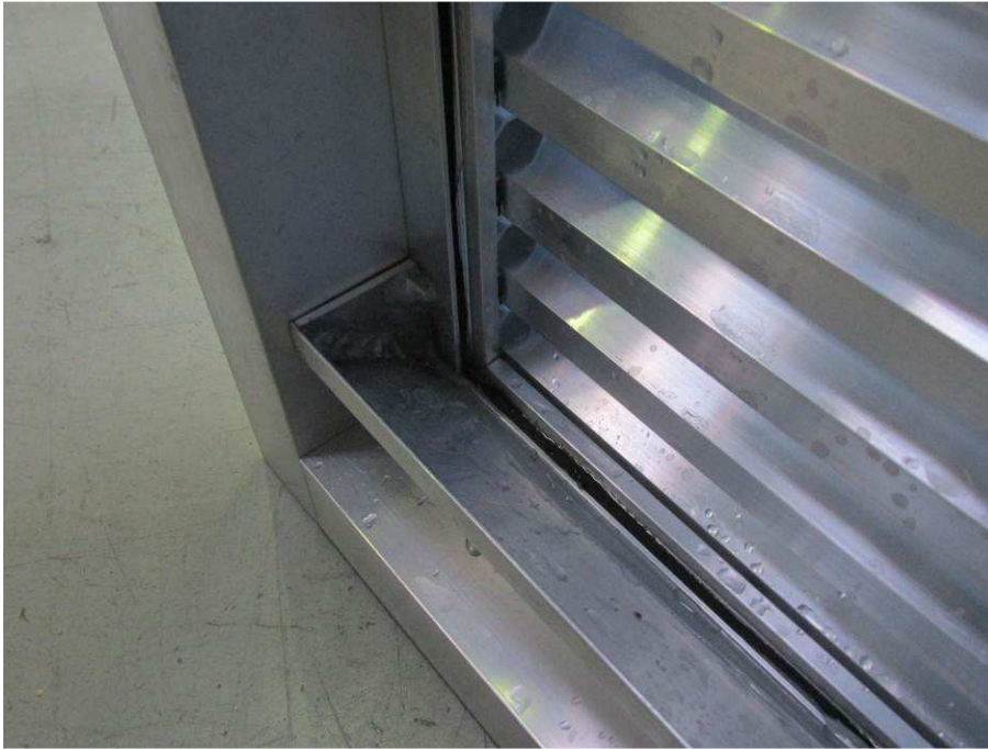
Bild 5 Darstellung der Wasserablaufschiene auf der Probekörperrückseite
