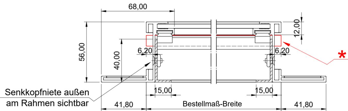
\* jede 2. Lamelle 10mm Rundmaterial, partiell mit Lamelle verschweißt
