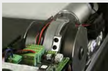
Die Modi "Full Power" oder "Low Energy" können einfach über die Elektronikplatine ausgewählt werden.
