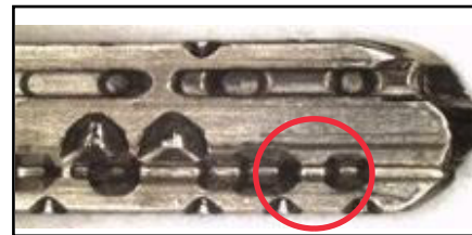
Abgenutzter Schlussel mit Verschleiss Spuren: tiefe Rille auf der rechten Seitenspur
