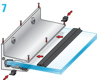
7 Fixieren Sie die Glasscheibe beidseitig mit den Sicherungsklötzen. Drücken Sie die vordere Auflagerdichtung zwischen Glas und Profil. Kleben Sie die Siliconpuffer in regelmäßigen Abständen auf Profilober- und vorderkante auf.
