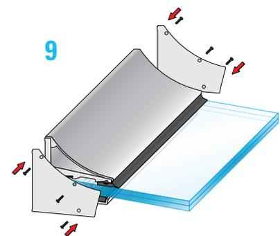
9 Fixieren Sie die Seitenabdeckungen und die Blende mit den Sicherungsschrauben.
