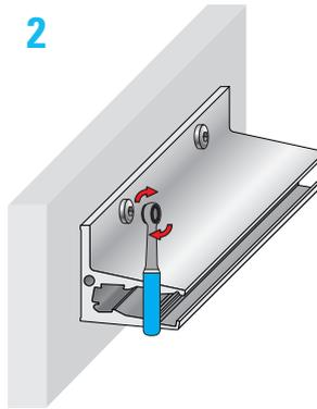
2 Befestigen Sie das Profil an der Unterkonstruktion bzw. dem Baukörper.
