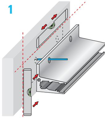
1 Richten Sie die Unterkonstruktion aus. Bestimmen Sie die Befestigungspunkte mit Hilfe des Profils.
