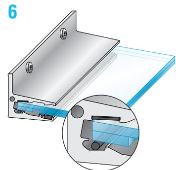
6 Führen Sie die Glasscheibe bis zum Profilanschlag ein.
