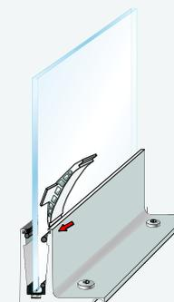
**11** Drücken Sie die Rundschnur mit dem Werkzeug in die dafür vorgesehenen Vertiefungen am Profil bis die Scheibe gerade ausgerichtet ist.
