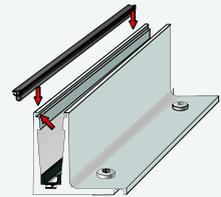
**4** Drücken Sie die äußere Dichtung in die Nut.
