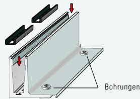
**3** Setzen Sie die Klemmschuh-Stücke bei jeder Bohrung ein.
