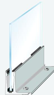
**7** Legen Sie alle 25 cm (bei jeder Bohrung) einen Klemmstab (je nach Scheibe) zwischen Profilkante und Scheibe.
