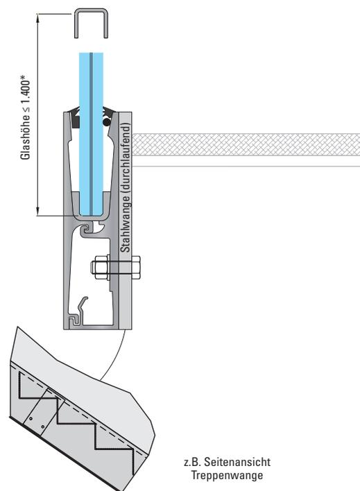
Auflagerhöhe min. 100 mm.
