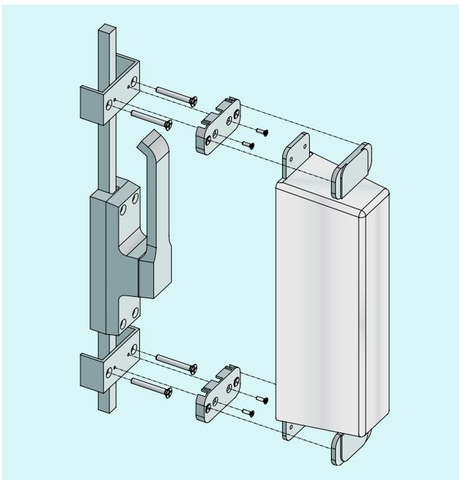
1. Die beiden Montagewinkel so auf das Türblatt schrauben, dass der Treibriegel unterhalb der Fluchttürhaube sitzt.
