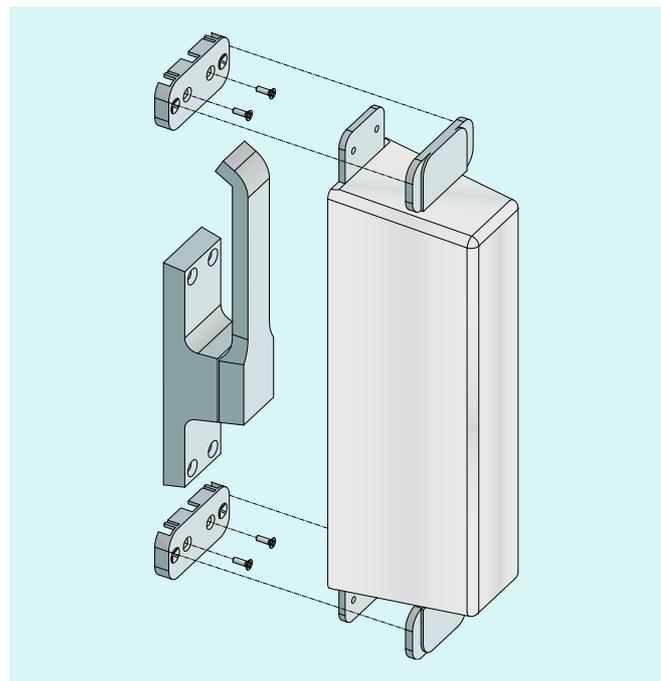
1. Die beiden grünen Befestigungsplatten mit den beigegeführten Schrauben montieren.
