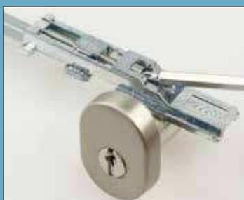
Sind Komfort-Beschlagteile, die nach den Anforderungen der DIN EN 13126-5 klassifiziert und geprüft sind. Bei Öffnungsweiten von 89 bzw. 100mm wird den Anforderungen der Sicherheitsfunktion nach DIN EN 13126-5:2015-01 „Begrenzer für die Sicherheit... um einen unbeabsichtigten Durchgang durch das Fenster zu verhindern“ entsprochen. Für den Einsatz an bodentiefen Fenster- bzw. Flügelementen gelten abweichende Regelungen der jeweiligen Landes- bzw. Sonderbauordnungen und die rechtlichen
