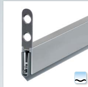
Option: Planet TW mit Haltewinkel für Holz, Schräglippe für wellige Böden
