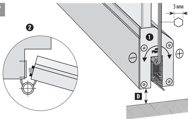
① Einstellen Hub mit Inbusschlüssel (3 mm), Bodenanpressung vermeiden! (siehe Dichtungshöhe ①), Funktionskontrolle; ② Spitze vom Band abgewendet
