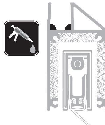
**Befestigungsarten:** Silikonkleber. Zuvor Klebeflächen reinigen nach Kleber-Hersteller-Anleitung.
