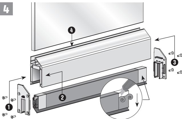
① Abdeckplatte aufstecken und festschrauben; ② Dichtung einsetzen und nach vorne schieben; ③ 2. Abdeckplatte aufstecken, festschrauben; ④ Klebstoffauftrag: siehe 5.
