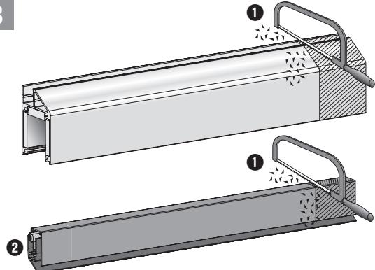
① Schutzprofil / Dichtung kürzen, Späne entfernen;
