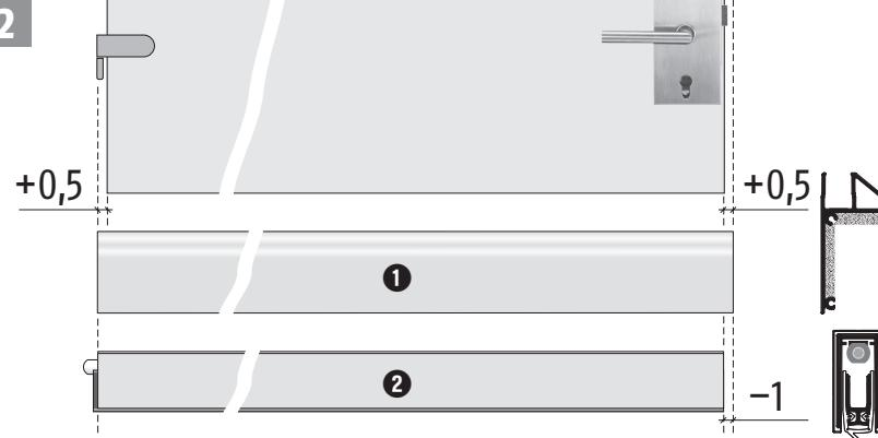
**Vorbereitung zum Kürzen:** ① Länge Schutzprofil = Glasbreite plus 1mm;
