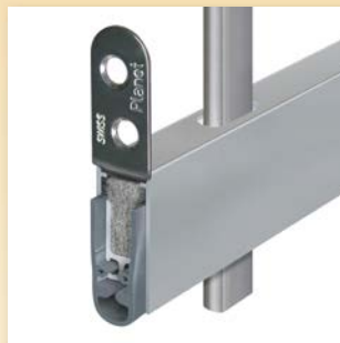
Option: Planet HS-plus mit Planet Bohrung \varnothing 5 \times 13 mm und Treibriegelstange → siehe Kapitel Zubehör | Treibriegel/-stangen
