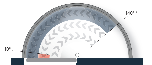
Schließkraftdiagramm ECO Newton TS-31, Bandgegenseite
