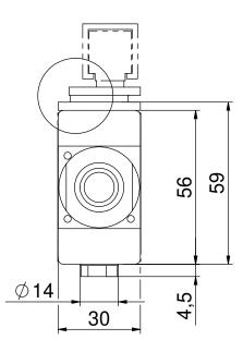
Wichtig: Bei Einsatz von Dichtungen Verfahrweg des Hebelarmes beachten! (Empfohlener Abstand 3mm)
