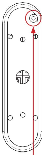
Cellule photoélectrique d'autoprotection. Pour l'activer se référer à la page 8/24 "Autoprotection"
